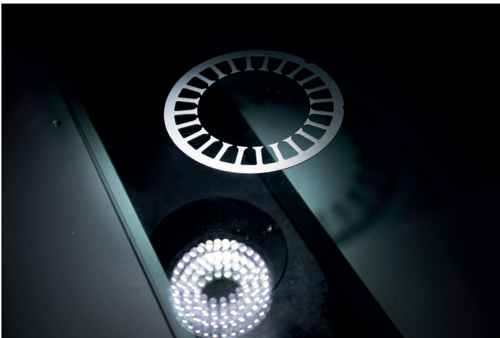
Контроль пластины статора электродвигателя на мультисенсорной системе INTEGRA STARK AU
