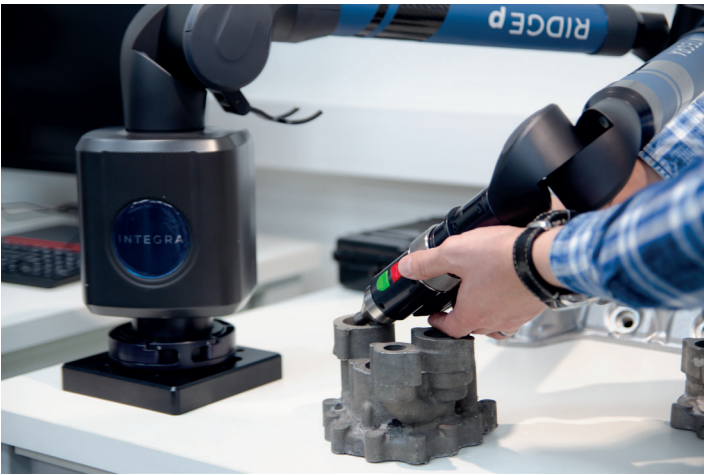
Контроль отливки корпуса распределителя мобильной КИМ INTEGRA RIDGE P
